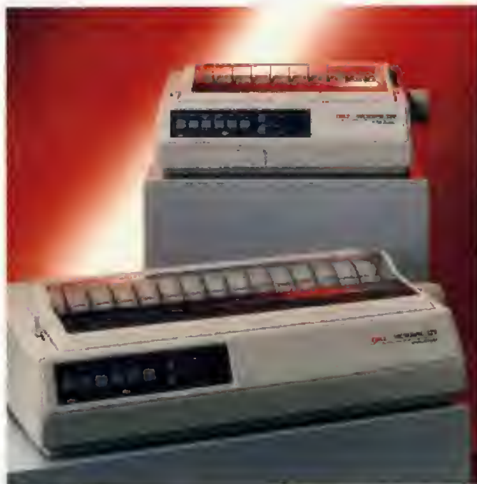
Die neuen 9-Nadel-Drucker von Oki drucken rekordverdächtig schnell: 300 Zeichen pro Sekunde Foto: Oki
